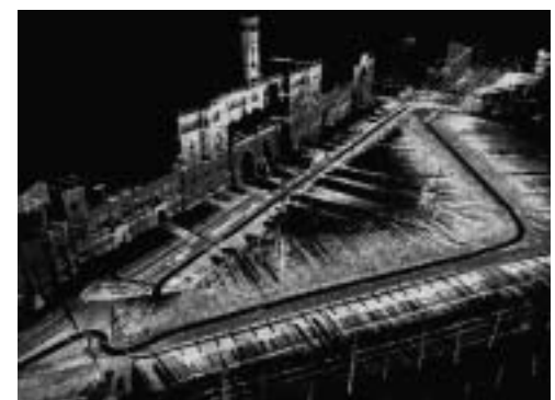
Hauptgebäude der Leibniz Universität Hannover, aufgenommen durch ein neu entwickeltes kinematisches Laserscansystem
